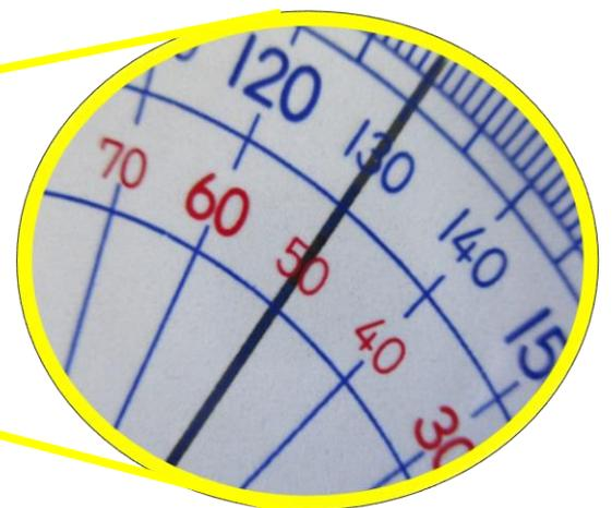
辺アウの上にある目もりをよみます。辺アイに合わせた  $0^\circ$  の線から、 $10^\circ$  ,  $20^\circ$  ,  $30^\circ$  ...とよみます。
